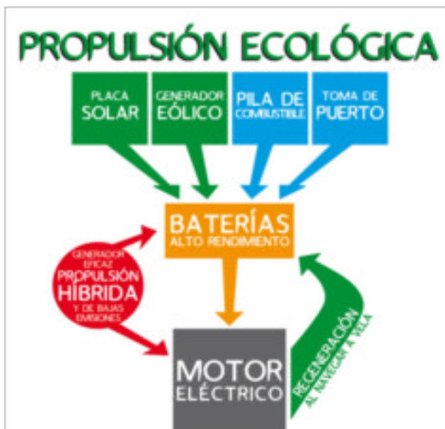
Esquema simple de los fundamentos de la propulsión ecológica- que pueden aplicarse a barcos de vela y motor.
