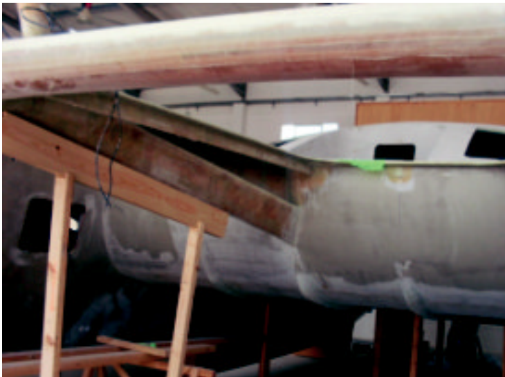
La gran altura del casco entre flotadores, 0,90 m, evita que se produzca el molesto «xoping» además de eliminar el roce con el agua, lo que representa evitar que se fugue energía.
